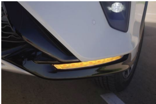
Luces intermitentes secuenciales
