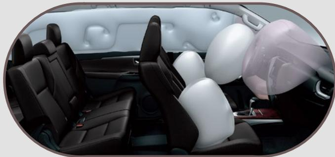
7 airbags: frontales (x2), de rodilla (conductor), laterales (x2) y de cortina (x2) Para más información acerca del sistema de airbags, ingresá a: [toyota.com.ar/mi-toyota/sistema-de-airbags](http://toyota.com.ar/mi-toyota/sistema-de-airbags)
